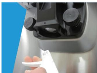
1-6 殺菌プラグにアルコールを吹きつけて、フロントに殺菌プラグの○マークが正面を向くように、真下から取りつけます。殺菌プラグを約60°～90°回してフロントに固定してください。
