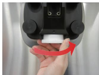
2 タンクカバーを取り外し、ミックスバルブを「開」から「閉」の位置に回します。
