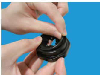
2-7 再度ノズルとフロントの製品出口にアルコールを吹きつけてから、フロントにノズルの○マークが正面を向くように、真下から取りつけます。ノズルを約60°~90°回してフロントに固定してください。
